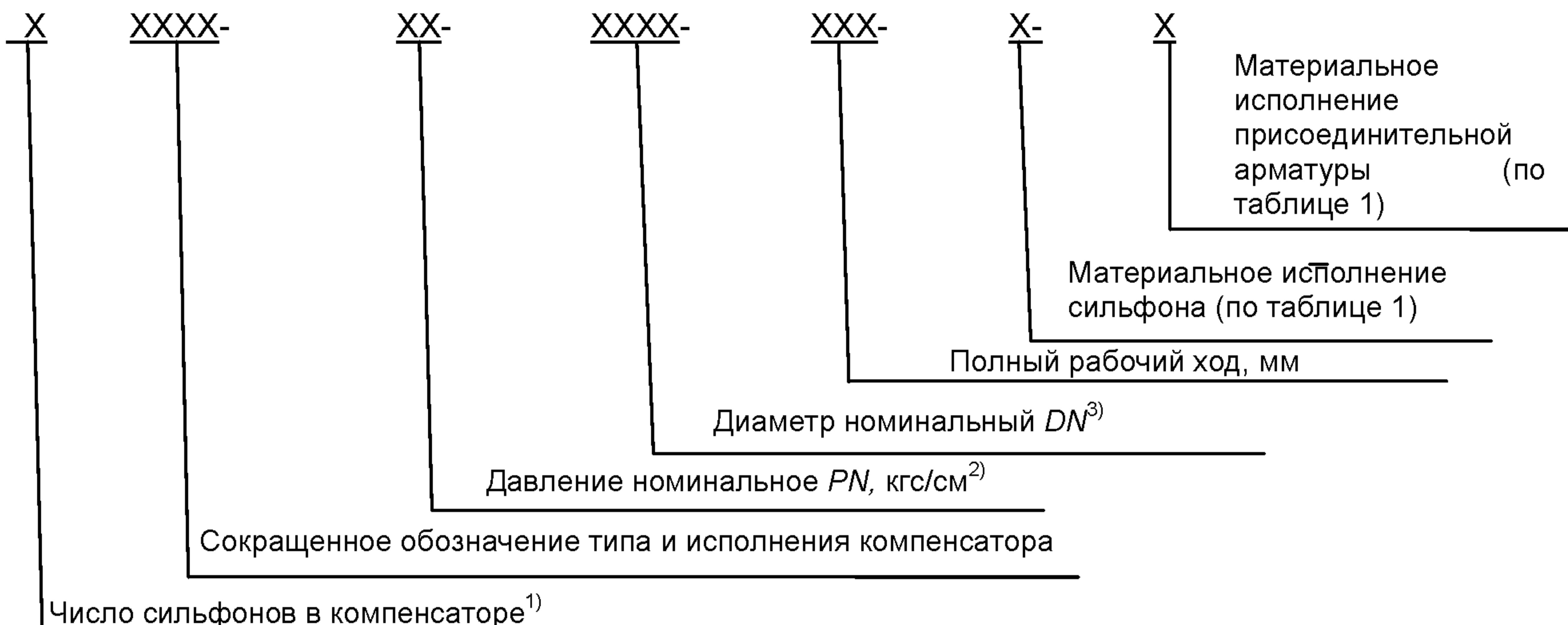
**A.2 Схема условных обозначений устройств**
